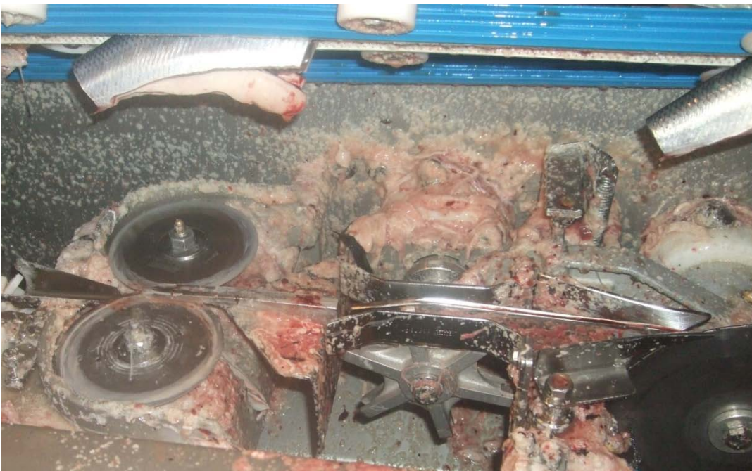
Figur 4 Filetmaskin som er stoppet under drift og hvor bukkutt er gjennomført.
